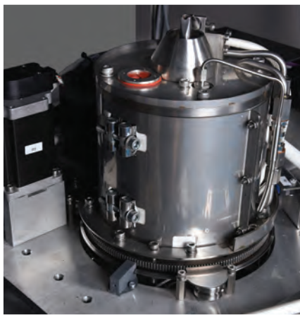
Rotierende, nicht- benetzbare Lötdüsen für weniger Wartung und Bedieneingriff
