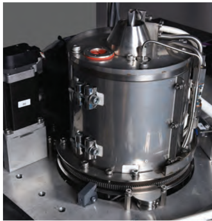
可旋转的非润湿型焊接喷嘴， 无需操作者介入/维护
